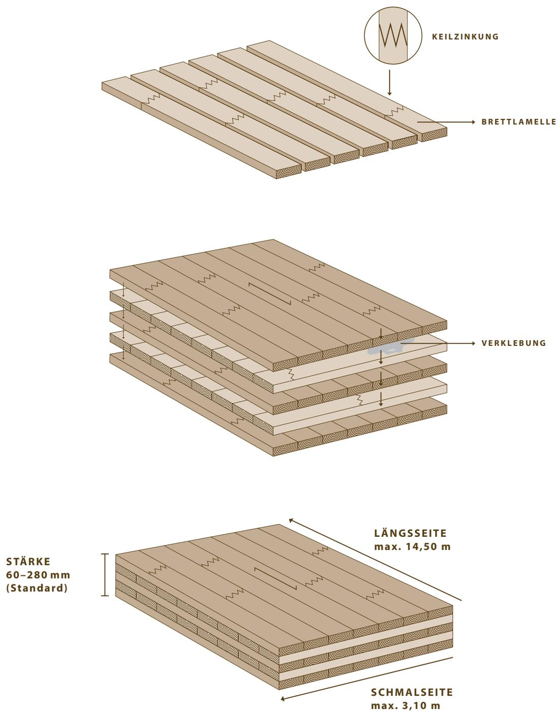
Weitere Erklärungen zum Prinzip und Aufbau einer PFEIFER CLT-Platte finden Sie auf den Seiten 18/19.
